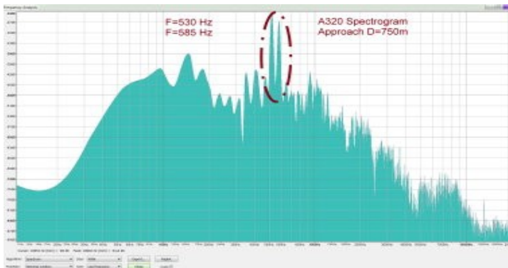
Spektrumgramm eines A320 beim Landeanflug
